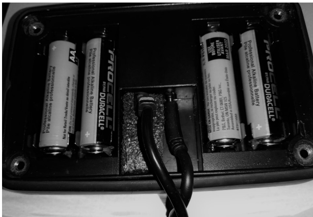
Fig. 1: Cable conectado. Retenedor de espuma
